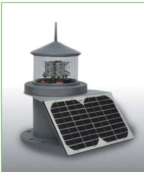
A MBL 160-SP é uma lanterna LED de luz solar autônoma, proporcionando uma faixa luminosa de até 9 milhas náuticas. Ideal para instalações perto do Equador ou com alto consumo de energia devido a um ciclo pesado.
