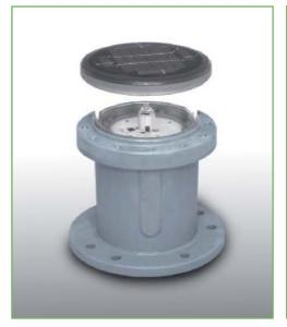
A MCL 140 é uma mini lanterna marítima LED, solar independente, que utiliza um único LED de alta potência, proporcionando um alcance luminoso de até 5 milhas náuticas. Caracteriza-se pelo excelente desempenho do seu sistema óptico, minimizando o consumo e oferecendo uma grande autonomia.
