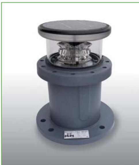
A MCL 160 é uma lanterna marítima LED compacta, solar autônoma solar, com excelente desempenho de seu sistema óptico e baixo consumo, equipada com diodos de LED de alta intensidade, proporcionando uma faixa luminosa de até 8 milhas náuticas e oferecendo uma grande autonomia.
