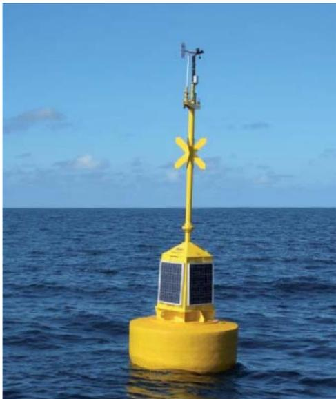
As Boias Oceanográficas EBM-OC são projetadas e fabricadas pela MSM, são unidades de medida de vários fatores ambientais, meteorológicos e oceanográficos que podem estar presentes no ambiente marítimo, especialmente indicadas para águas abrigadas e em alto-mar.
